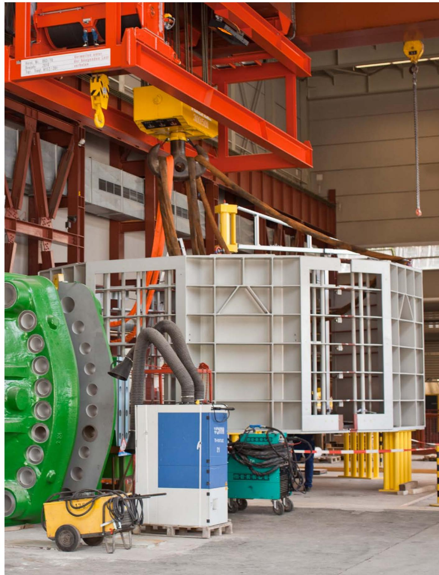
Dieser Stahlriese dient später viele Meter unter der Erde als Stator, in dem sich im Kraftwerksbetrieb der Rotor dreht.
